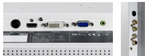
Mehrere Videoeingänge (VGA, DVI-D, HDMI, CVBS, S-Video, DisplayPort)
